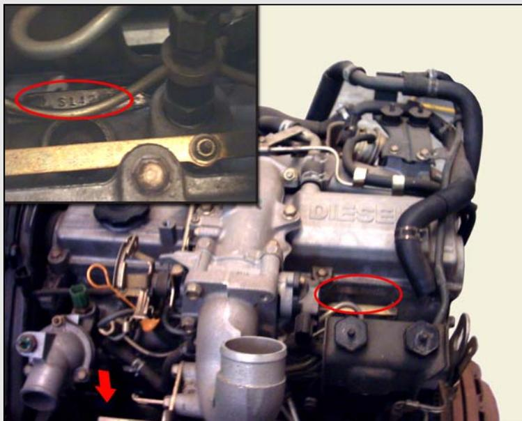
O local de gravação do motor Diesel (Mazda) que equipa os veículos fabricados até 2001 está localizado na parte inferior do bloco do motor, lado esquerdo dianteiro (seta). Existe também entre o cabeçote e o bloco do motor uma gravação com o número de série para facilitar a identificação, pois a gravação completa que fica no bloco do motor é de difícil acesso.
