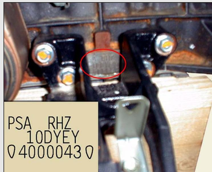
**PSA RHZ:** Fabricante e Tipo de Motor
