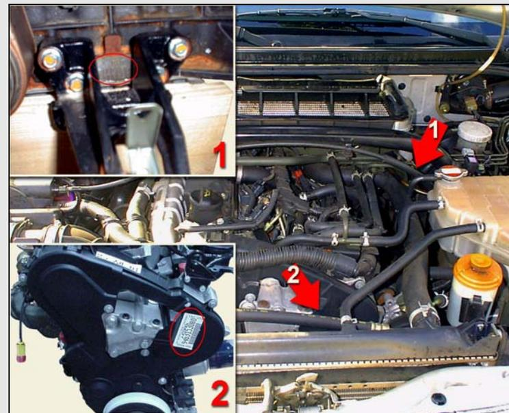
Para veículos a partir de 2002 está localizada próximo ao suporte do coxim do motor (1). (devido a localização de difícil acesso, há uma etiqueta de identificação (2) localizada na tampa da distribuição).
