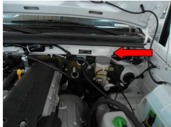
D) O número do motor se localiza no lado esquerdo do bloco do motor, parte traseira, próximo do coletor de escapamento, conforme seta.
