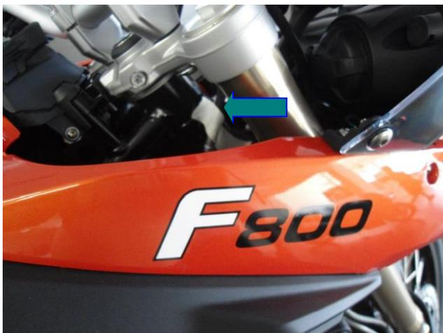
B) O número do motor esta gravado no bloco do motor lado direito abaixo do cilindro, conforme seta.
