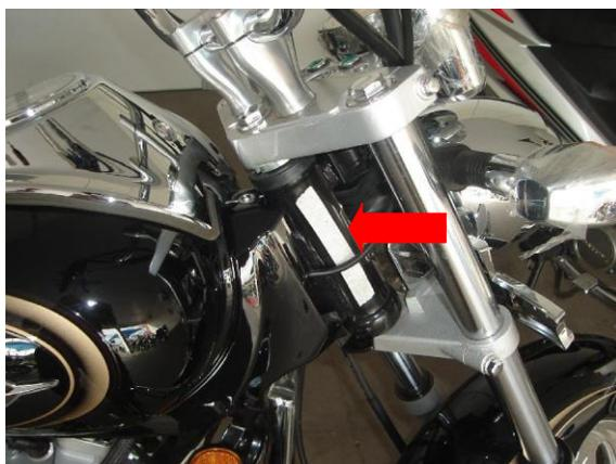
B) O número do motor se localiza gravado no bloco do motor e em uma plaqueta removível, lado esquerdo, conforme seta.
