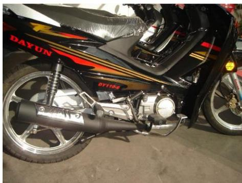
A) O chassi se localiza no lado direito da moto próximo do pedal, conforme seta.
