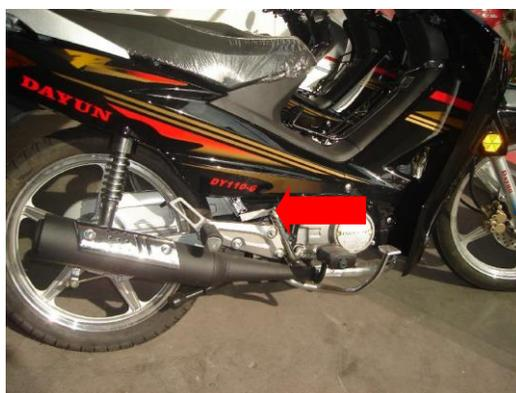
B) O número do motor se localiza gravado no bloco do motor e em uma plaqueta removível, lado esquerdo, conforme seta.
