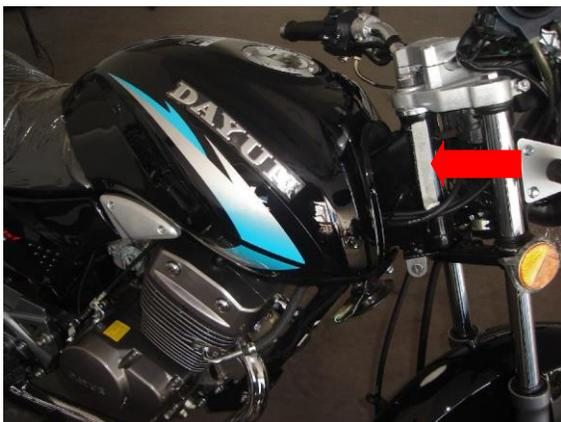
B) O número do motor se localiza gravado no bloco do motor, lado esquerdo, conforme seta.
