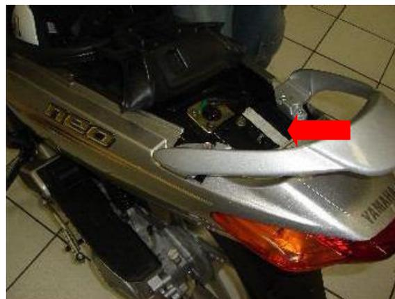
B) O número do motor se localiza no bloco do motor, lado esquerdo, acima da correia dentada, ao lado do amortecedor, conforme seta.
