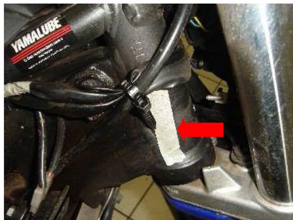
B) O número do motor se localiza no bloco do motor, lado direito, abaixo do corpo de injeção eletrônica.
