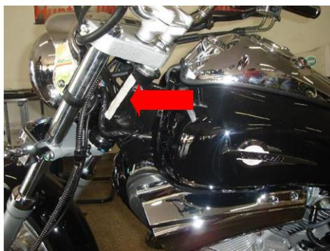
B) O número do motor se localiza gravado no bloco do motor, lado esquerdo, abaixo do cabeçote, conforme seta.
