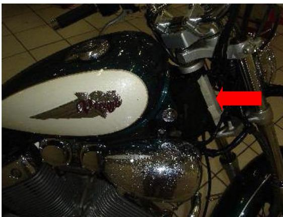
B) O número do motor se localiza no bloco do motor, lado direito, abaixo do cilindro em V.
