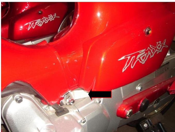
B) O número do motor, se localiza gravado no bloco do motor, lado esquerdo, conforme seta verde; chassi seta amarela.
