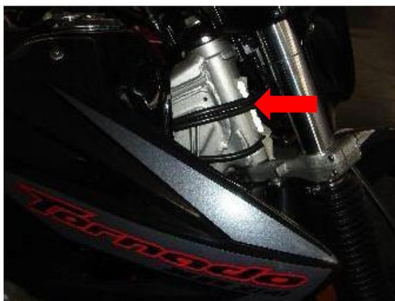
B) O número do motor se localiza no bloco do motor, lado esquerdo, próximo ao pedal de câmbio.
