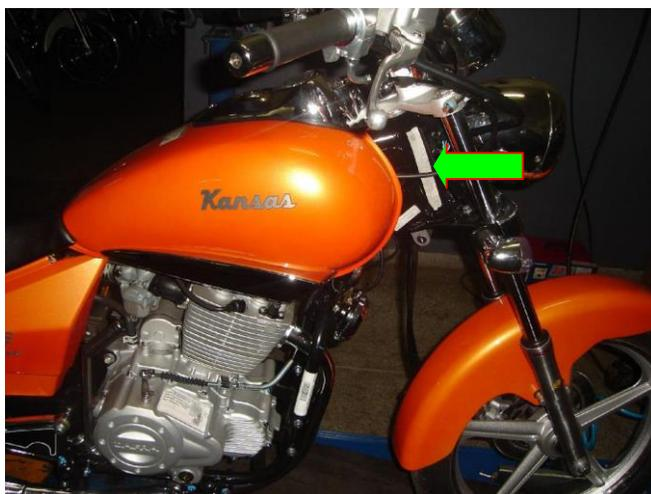
B) O número do motor esta gravado no bloco do motor lado esquerdo, conforme seta.
