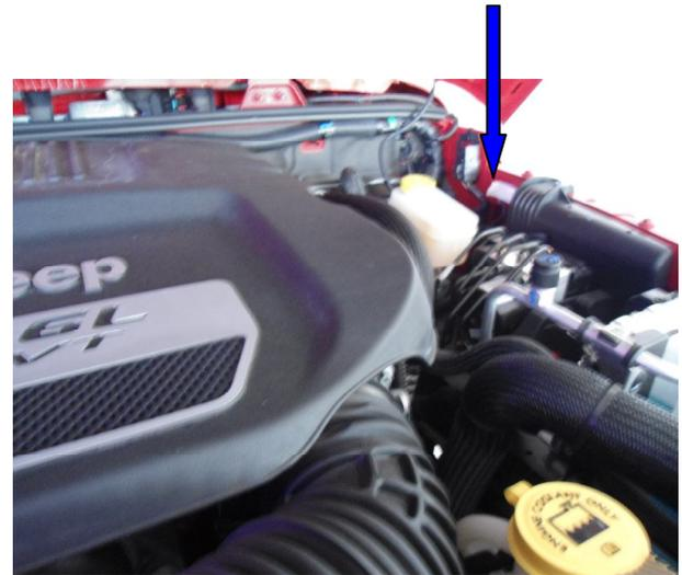
D) O número do motor se localiza no bloco do motor, na parte traseira e lado esquerdo, próximo do câmbio.
