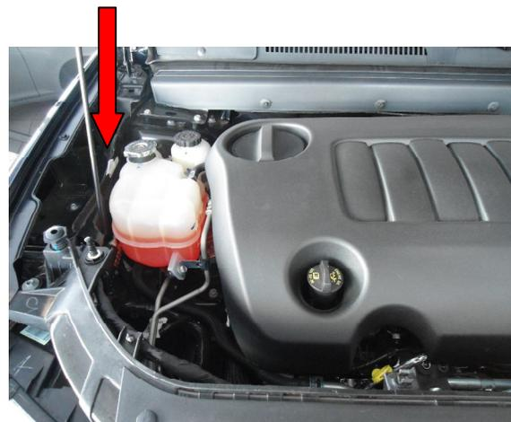
D) O número do motor se localiza no bloco do motor, na parte traseira e lado esquerdo, próximo do câmbio.
