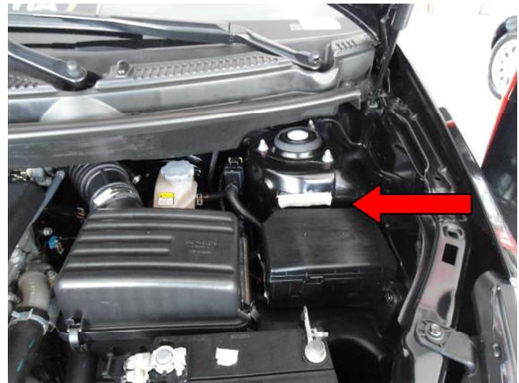
**D) O número do motor se localiza no bloco do motor, na parte frontal e lado direito, logo abaixo do coletor de escape, conforme seta.**
