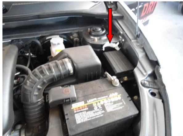
D) O número do motor se localiza no bloco do motor, na parte traseira e lado esquerdo, logo abaixo do coletor de escape, conforme seta.
