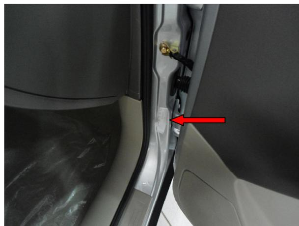
D) O número do motor se localiza na parte traseira do bloco do motor, próximo ao espansor de água, em local de difícil acesso. No lado direito, em uma etiqueta, também está impresso o número do motor, vide seta.
