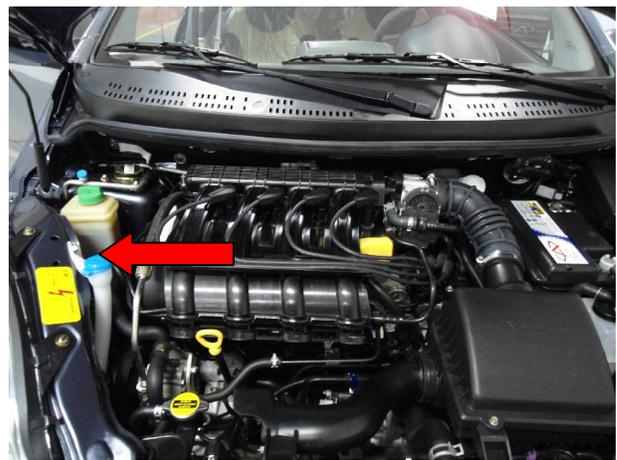
D) O número do motor se localiza na parte traseira do bloco do motor, próximo ao alternador, em local de difícil acesso. Em cima da correia dentada, em uma etiqueta também está impresso o número do motor, vide seta.
