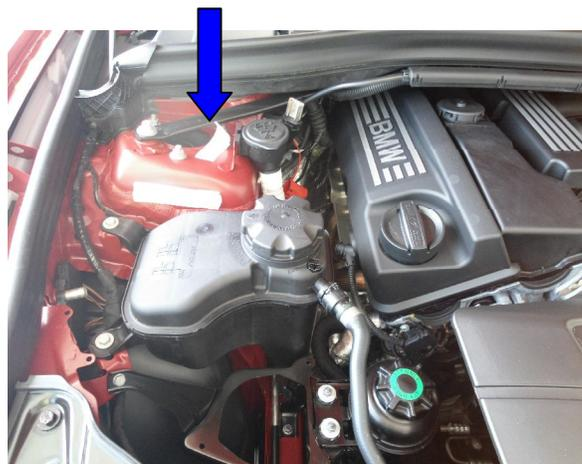
D) O número do motor se localiza no bloco do motor, na parte frontal do motor, próximo da junção do bloco e do cabeçote, vide seta.
